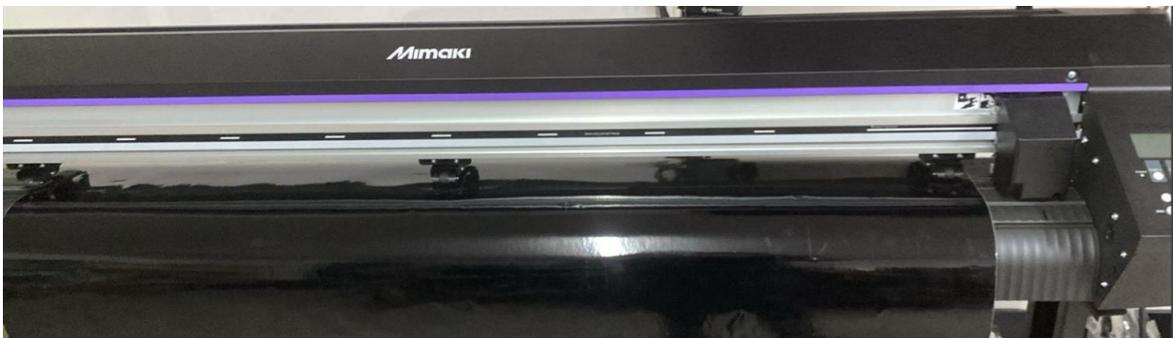
Baje los rodillos para que aprieten el material, use la palanca para subir y bajar rodillos, esa palanca se encuentra, en la parte posterior al panel de control. Al terminar la pantalla del plotter, mostrara la siguiente información.
