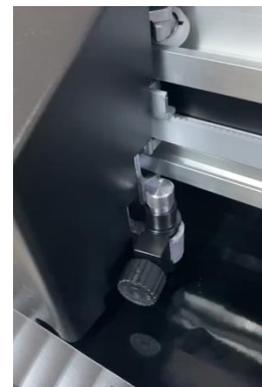
Coloque la porta navaja en el sujetador del cabezal de corte
