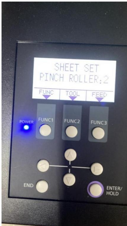
Si el material es ancho estamos usando 3 ruedas, en caso de usar ancho menor de 60 puede usar 2 a 3 pinch roller, como usted considere <apriete la flecha hacia arriba, para que cambie a 3> y después oprimir enter.4
